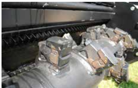
Dents en carbure fixées par un seul boulon
